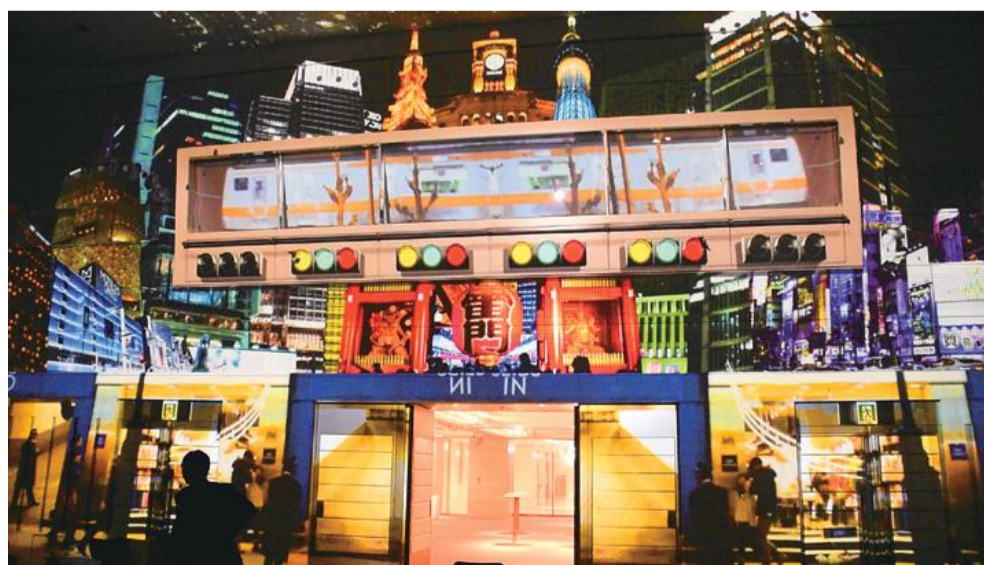
浮世絵から実写までさまざまな形で「街」を表現したプロジェクションマッピング。EB-L25000U(25000lm)1台・EB-L1750U(15000lm)2台の計3台すべてWUXGA。現場調整は1人で約6時間。
