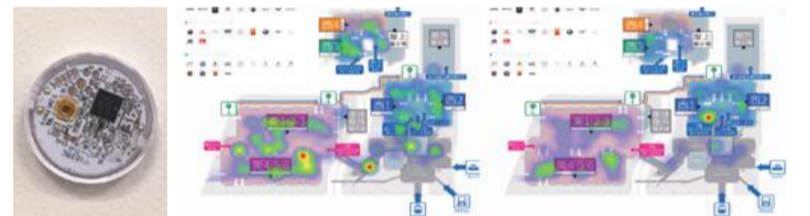
ビーコンを設置。GPSが届かない屋内でも正確な位置を計測
